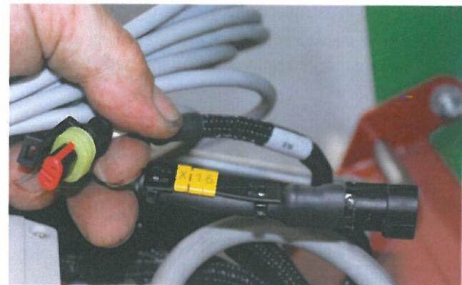
Bild 78. Signalledningen (Strautmann, X16)
