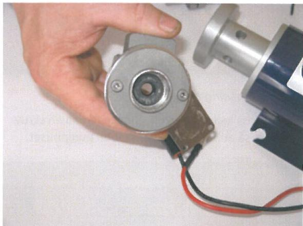
Bild 42. Lagerhusstätning
