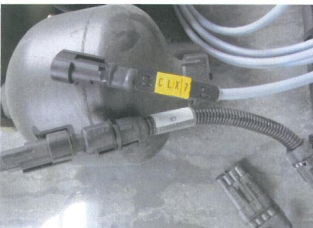
Bild 77. Signalledningen (Claas, CLX 7)
