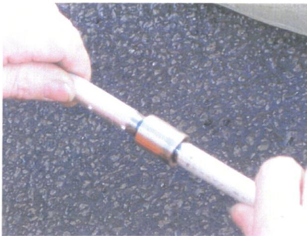
Bild 83. Montering av munstycksröret
