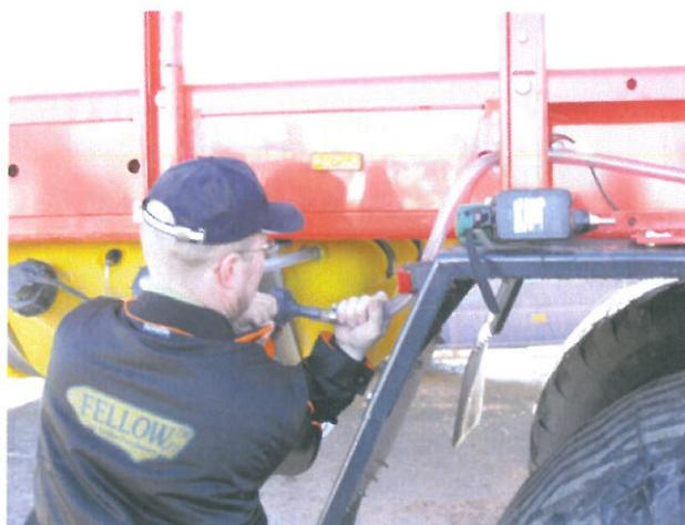
Bild 66. Kopplingen av sugslang till filterhus
