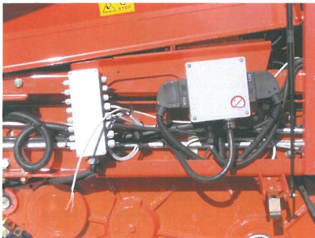
Bild 71. Elektrisk kopplingsdosa och signalledning
