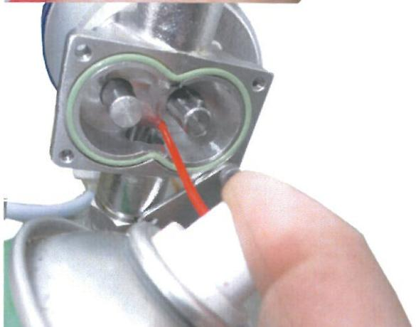
Bild 31. Pumpens smörjning
