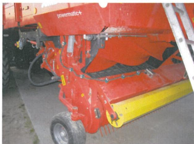
Bild 97. Foderflödesgivarens ledning och skydd
