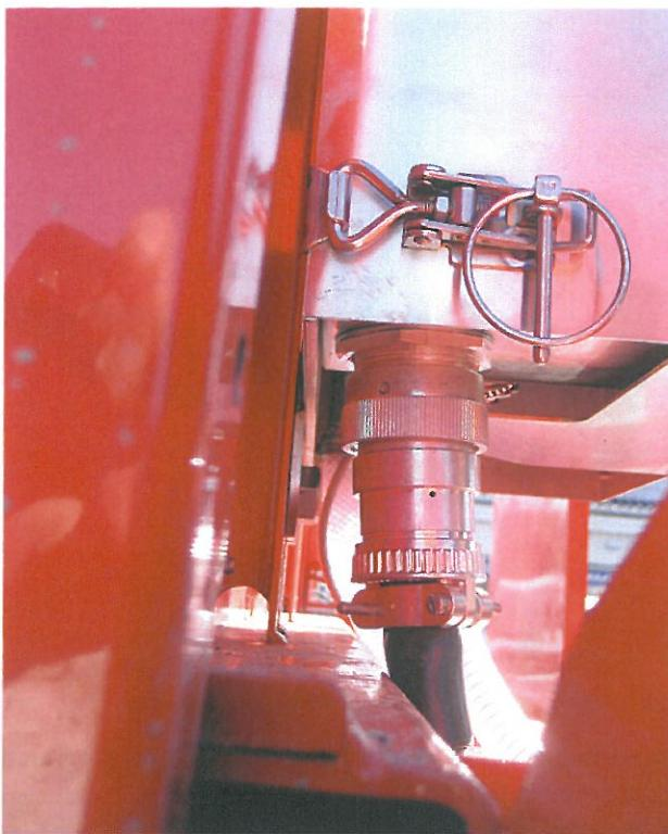
Bild 101. Fästning av styrsystemkabeln
