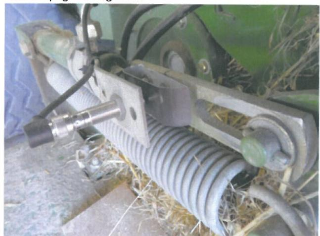
Bild 79. Balpressens signalledning (extra utrustning)
