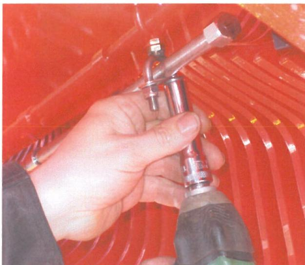
Bild 88. Montering av munstycksröret
