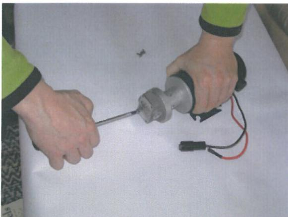
Bild 33. Lossning av pumpens lock
