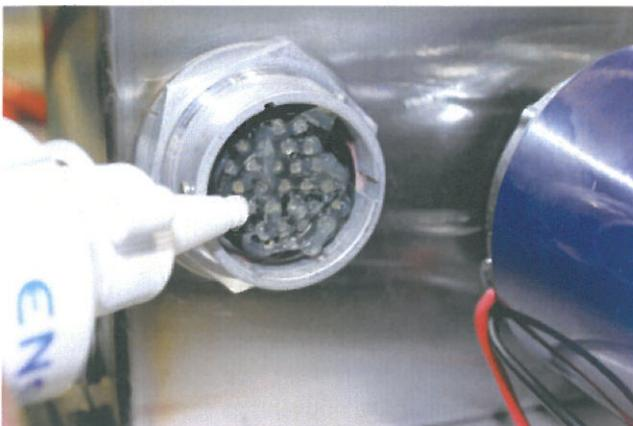
Bild 80. Smörjning av anslutningarna före montering.
