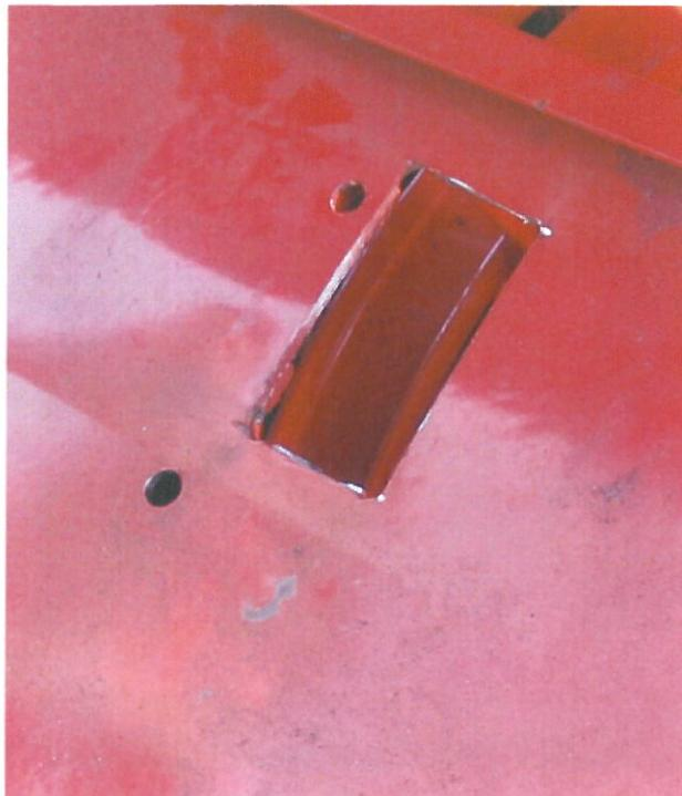
Bild 92. Montering av foderflödesgivaren
