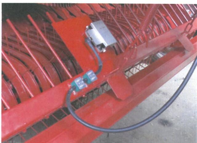
Bild 100. Foderflödesgivarens ledning och skydd
