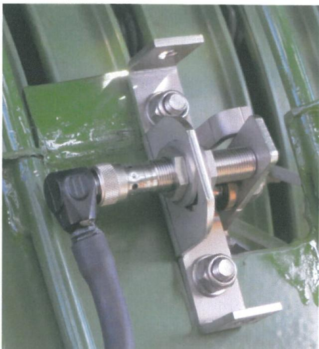
Bild 99. Foderflödesgivare
