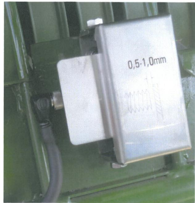
Bild 94. Foderflödesgivare med kåpan
