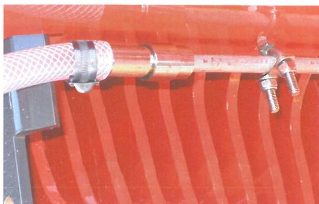
Bild 89. Montering av munstycksröret
