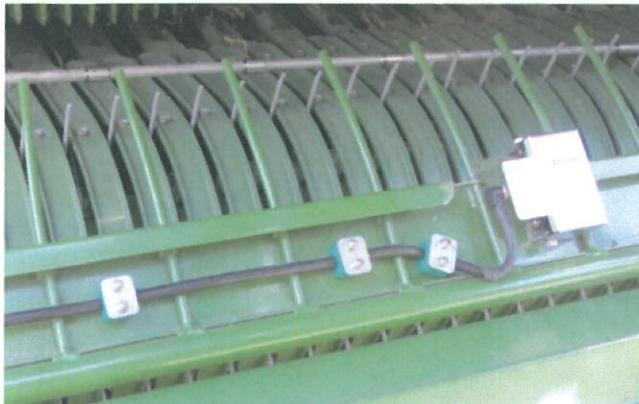
Bild 98. Foderflödesgivarens ledning och skydd
