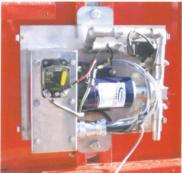
Bild 63. Pumpkåpan efter fästningen
