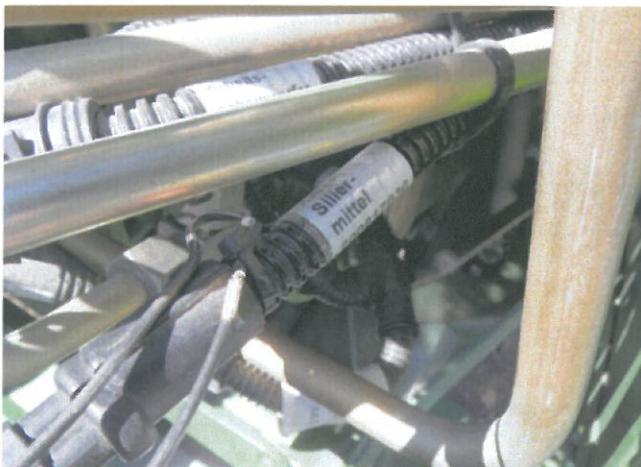
Bild 76. Signalledningen (Krone, XA1a Siliermittel)
