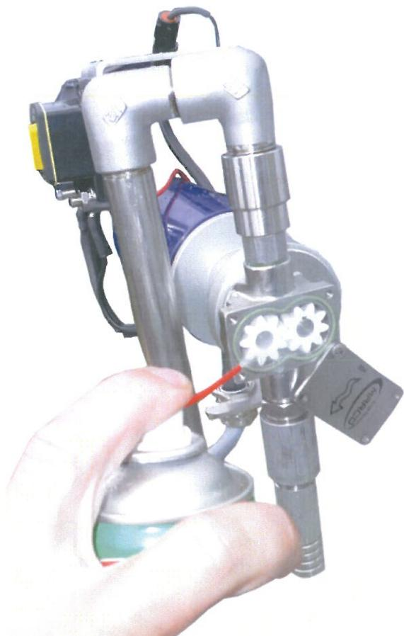
Bild 29. Pumpens smörjning
