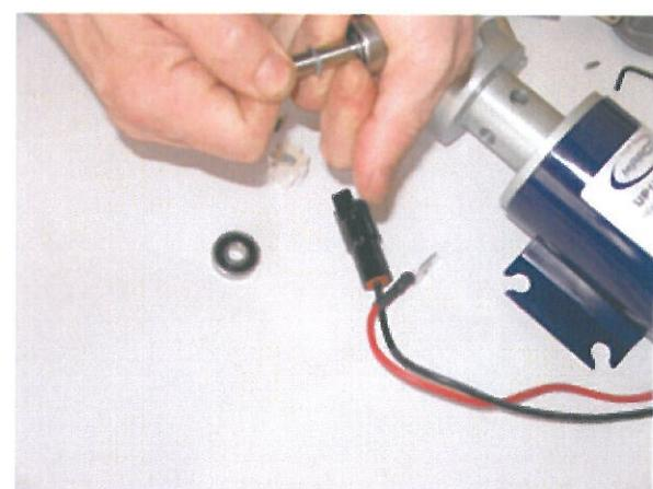
Bild 47. Losstagnings av lager
