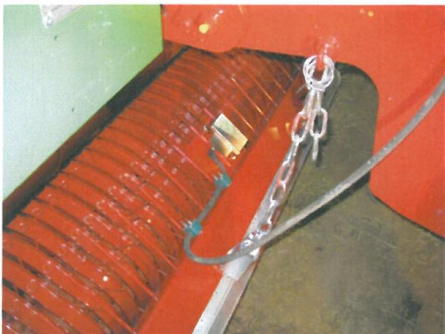
Bild 96. Foderflödesgivarens ledning och skydd
