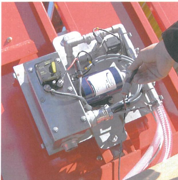
Bild 90. Kopplingen av foderflödesgivarens ledning
